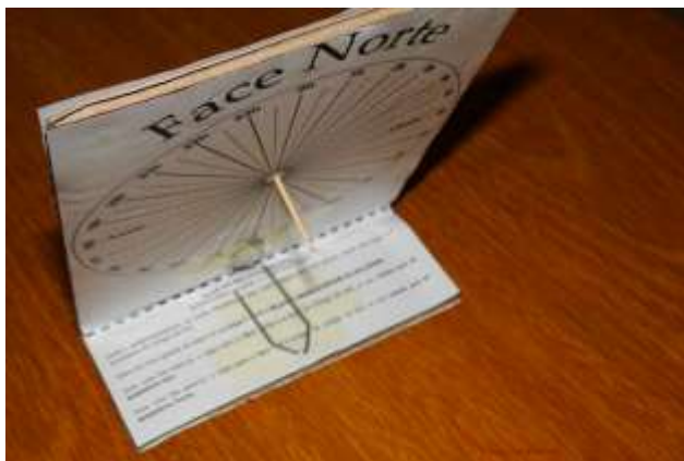
Figura 4. Detalhe da fixação do clipe para uma localidade no hemisfério Sul.
