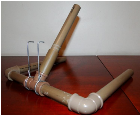
Fig. 8. Detalhe da montagem dos 3 canos de 20 cm, dos 2 de 10 cm, 1 de 5 cm, 2 cotovelos e 1 "te"
