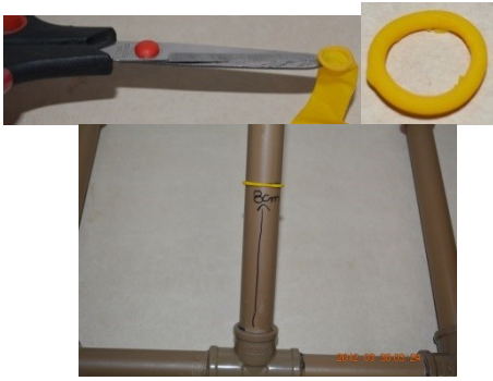
Fig. 13. Colocação do anel do balão a 8 cm acima do "te".
