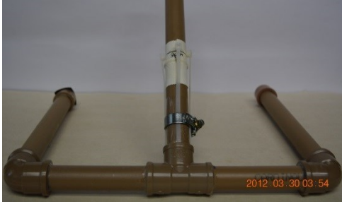
Fig. 16. Base com as 4 abraçadeiras de nylon presas com a abraçadeira de metal.
