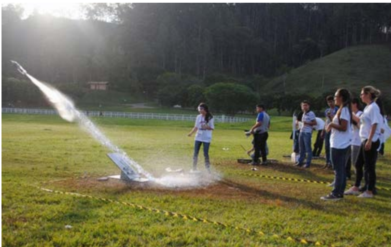
Fig. 16. Foto ilustrativa de um foguete de garrafa PET, recém-saído de sua base de lançamento usando como combustível vinagre e bicarbonato de sódio.
