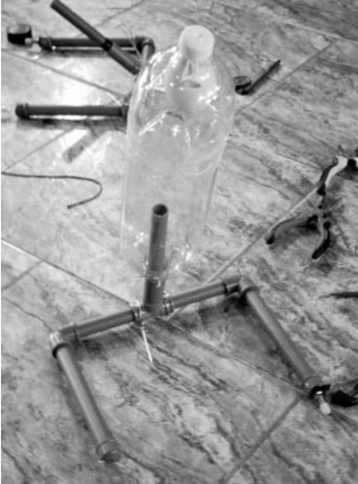
Foguete de garrafa pet e base de lançamento com tubo de PVC
