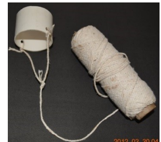
Fig. 18. Gatilho de liberação do foguete.
