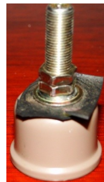
Fig. 9. Detalhes da válvula de pneu de bicicleta preso no "cap".
