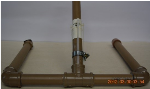
Fig. 16. Base com as 4 abraçadeiras de nylon presas com a abraçadeira de metal. Use 8 abraçadeiras!
