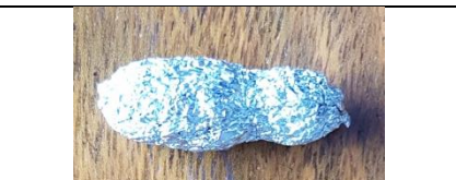
Fig. 11. A bolinha, entre as mãos torna-se um cilindro com as pontas parabólicas. Amasse ainda mais uma das pontas para caber dentro do tubo. A outra ponta deve ficar com um diâmetro ligeiramente maior do que o do tubo do foguete.
