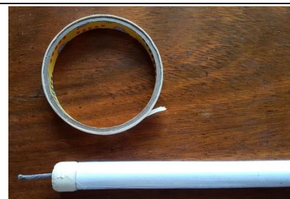
Fig. 8. Enrolamos sobre a parte visível do motor (cerca de 1 cm), várias voltas de fita crepe de forma que o diâmetro do motor passou a ser maior do que o do tubo. Assim não tem como o motor entrar no tubo.
