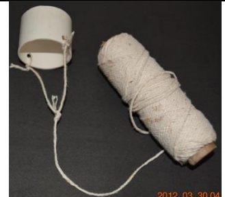
Fig. 18. Gatilho de liberação do foguete.
