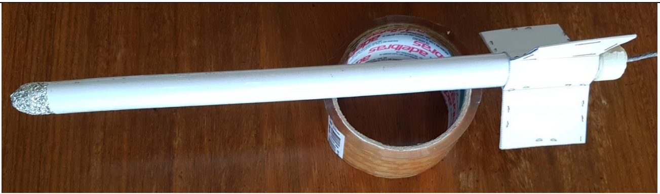
Fig. 21. Empenas acopladas à base do foguete.
