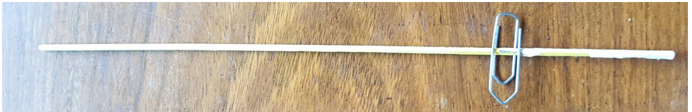
Fig. 23. Clipse de papel fixado perpendicularmente à vareta cerca de 10 cm da ponta onde estava o "motor".
