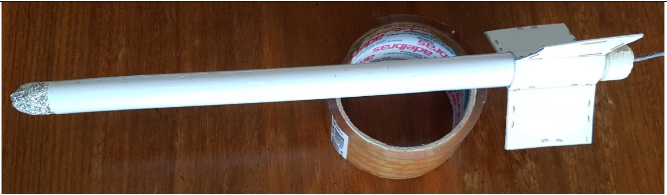
Fig. 21. Empenas acopladas à base do foguete.
