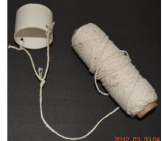
Fig. 18. Gatilho de liberação do foguete.
