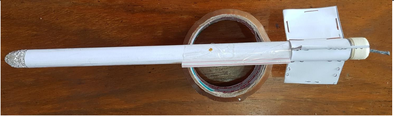
Fig. 22. A guia de lançamento (meio canudo de refrigerante) fixada na parte inferior do foguete ao longo do seu comprimento.
