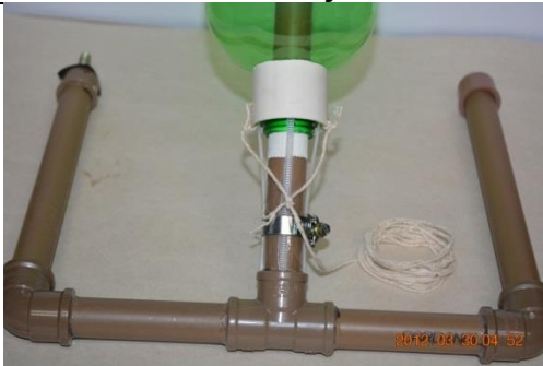
Fig. 19. Base com anel branco posicionado sobre as 4 "cabeças" de nylon.
