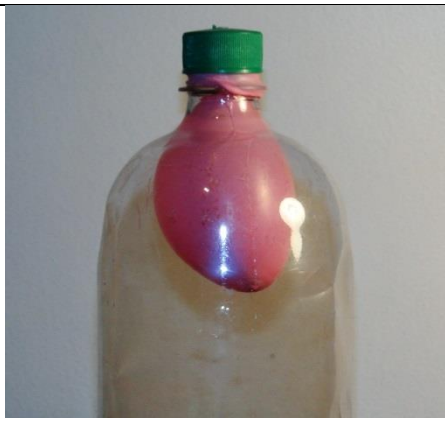
Fig. 1. Detalhe do "peso" preso dentro da ponta do foguete
