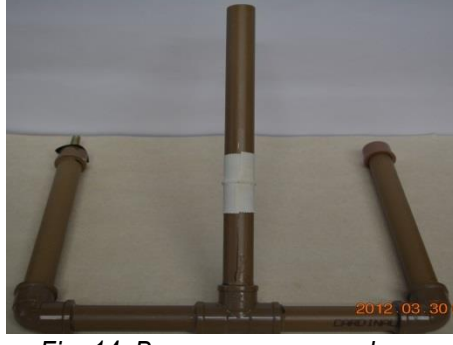
Fig. 14. Base com o esparadrapo sobre o bico do balão de aniversário.
