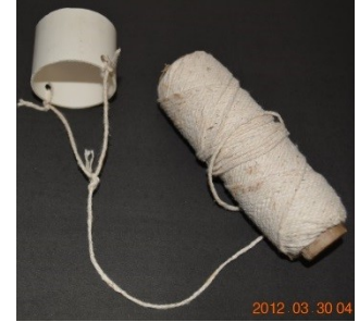
Fig. 18. Gatilho de liberação do foguete.
