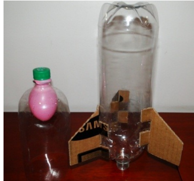
Fig. 5. Bico e foguete com aletas presas.
