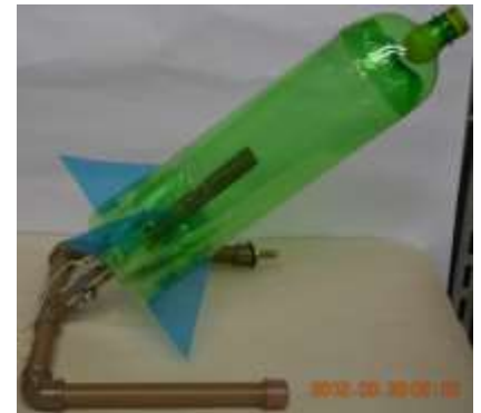
Fig. 21. Foguete pronto sobre a base.
