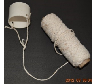
Fig. 18. Gatilho de liberação do foguete.
