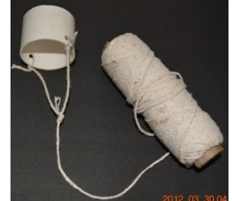
Fig. 18. Gatilho de liberação do foguete.
