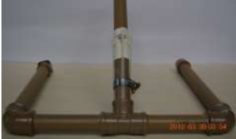
Fig. 16. Base com as 4 abraçadeiras de nylon presas com a abraçadeira de metal.
