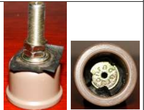
Fig. 9. Detalhes da válvula de pneu de bicicleta preso no "cap".
