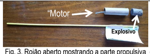
Fig. 3. Rojão aberto mostrando a parte propulsiva ou "motor" (longa com estopim ou pavio), e a parte explosiva (pequeno cilindro à direita)
