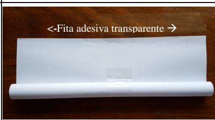
Fig. 5. Enrolando o papel ao redor do motor, fazendo assim o tubo do foguete. A fita adesiva no meio da folha só foi colocada para tirar a foto
