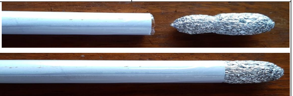
Fig. 12. Colocação da coifa (ponta) no tubo do foguete.
