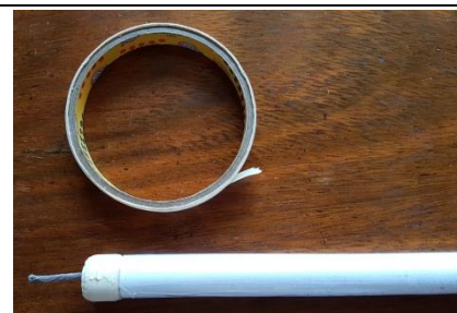
Fig. 8. Enrolamos sobre a parte visível do motor (cerca de 1 cm), várias voltas de fita crepe de forma que o diâmetro do motor passou a ser maior do que o do tubo. Assim não tem como o motor entrar no tubo.
