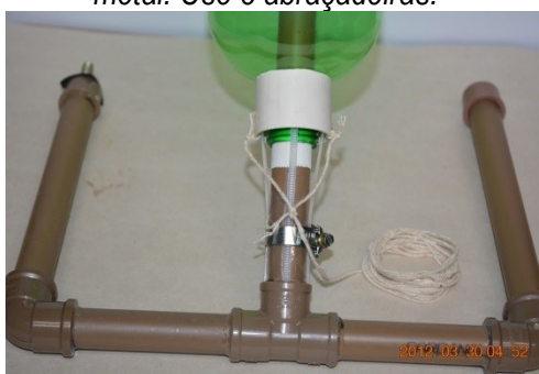
Fig. 19. Base com anel branco posicionado sobre as 4 "cabeças" de nylon.
