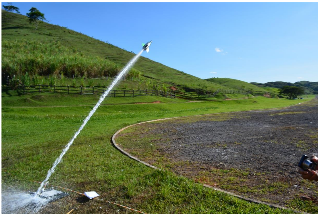
Foto 3. Foto ilustrativa de um foguete de garrafa PET, recém-saído de sua base de lançamento usando como combustível vinagre e bicarbonato de sódio.
