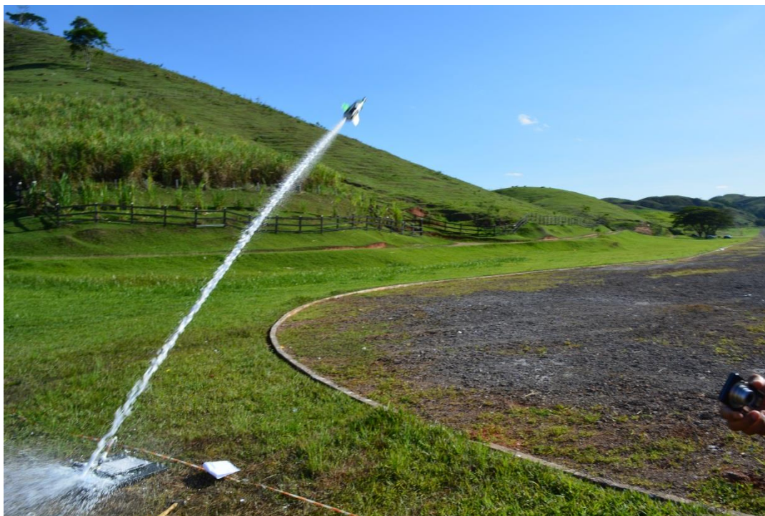
Foto 1. Foto ilustrativa de um foguete de garrafa PET, recém-saído de sua base de lançamento usando como combustível vinagre e bicarbonato de sódio.
