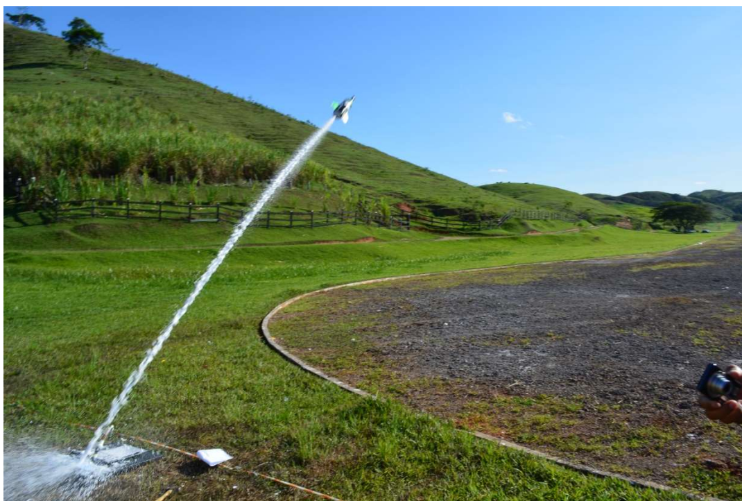
Figura 42. Foto ilustrativa de um foguete de garrafa PET, recém-saído de sua base de lançamento usando como combustível vinagre e bicarbonato de sódio.
