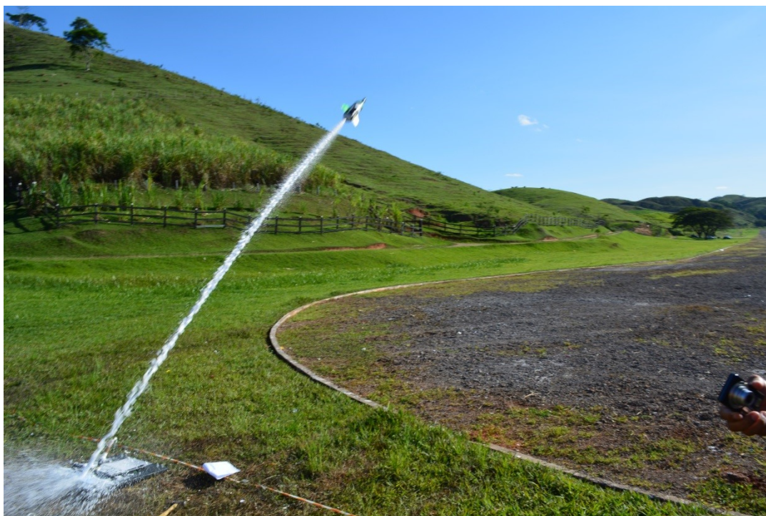
Figura 22. Foto ilustrativa de um foguete de garrafa PET, recém-saído de sua base de lançamento usando como combustível vinagre e bicarbonato de sódio.
