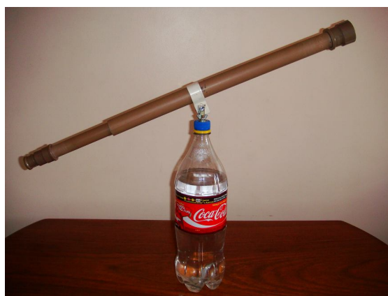
Fig. 14. Imagem da Luneta feita com lentes Optovac e canos de PVC sobre o tripé de baixo custo.
