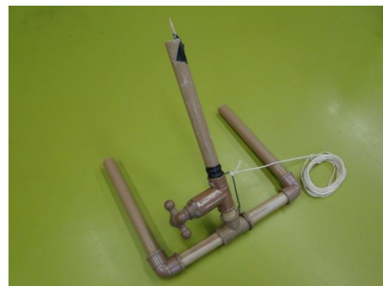
Figura 9. A base de lançamento montada.
