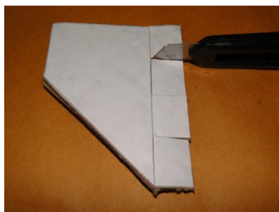
Figura 3. Detalhe do corte da aleta
