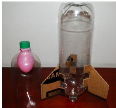
Fig. 5. Bico e foguete com aletas presas.
