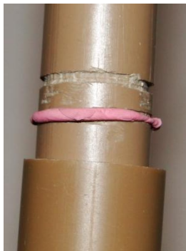
Fig. 8. Detalhe da montagem dos 3 canos de 20 cm, dos 2 de 10 cm, 1 de 5 cm, 2 cotovelos e 1 "te"
