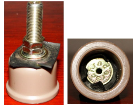
Fig. 10. Detalhes da válvula de pneu de bicicleta preso no "cap".
