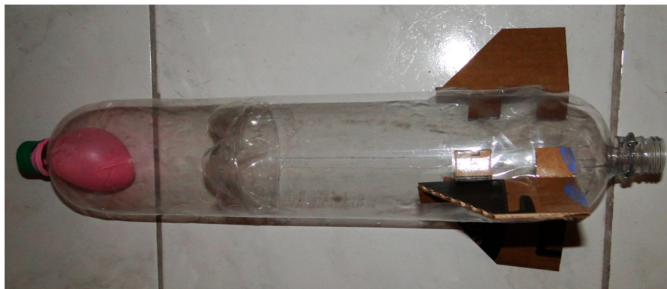
Fig. 7. Foguete finalizado, com bico, peso sob o bico, corpo com aletas e "brincos" no bocal.
