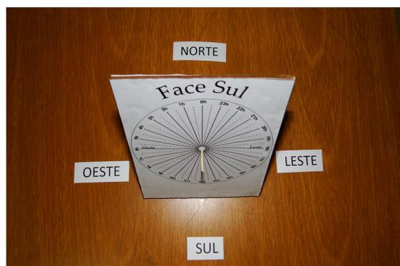
Figura 5. Posição final do Relógio de Sol, para uma localidade no hemisfério Sul.
